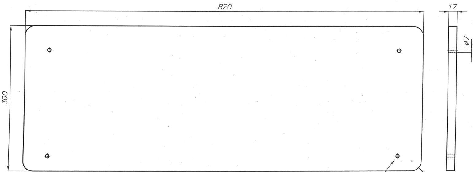
Löcher für Befestigung an Halterung anpassen
